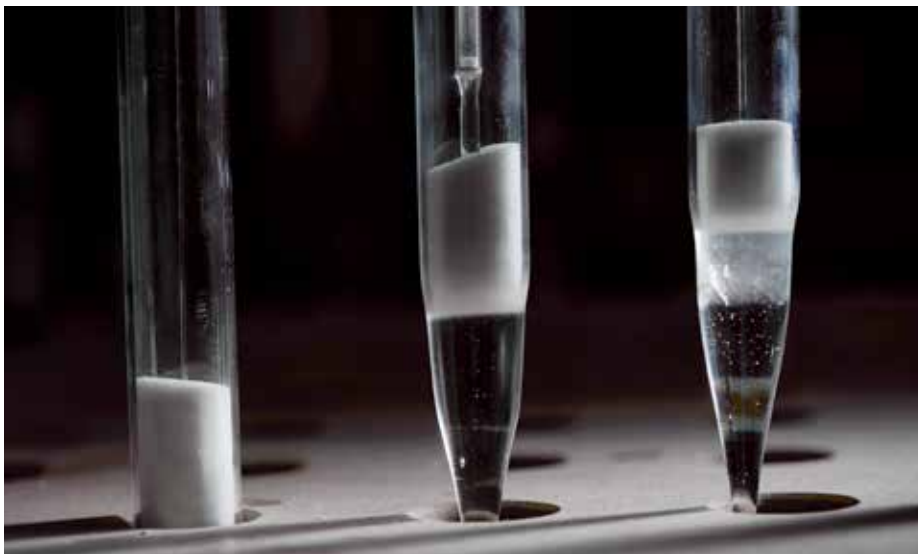
Daraus entstehen Faserlaser: Quarzsand im Spezialglas, dotiert mit Seltenen Erden.
