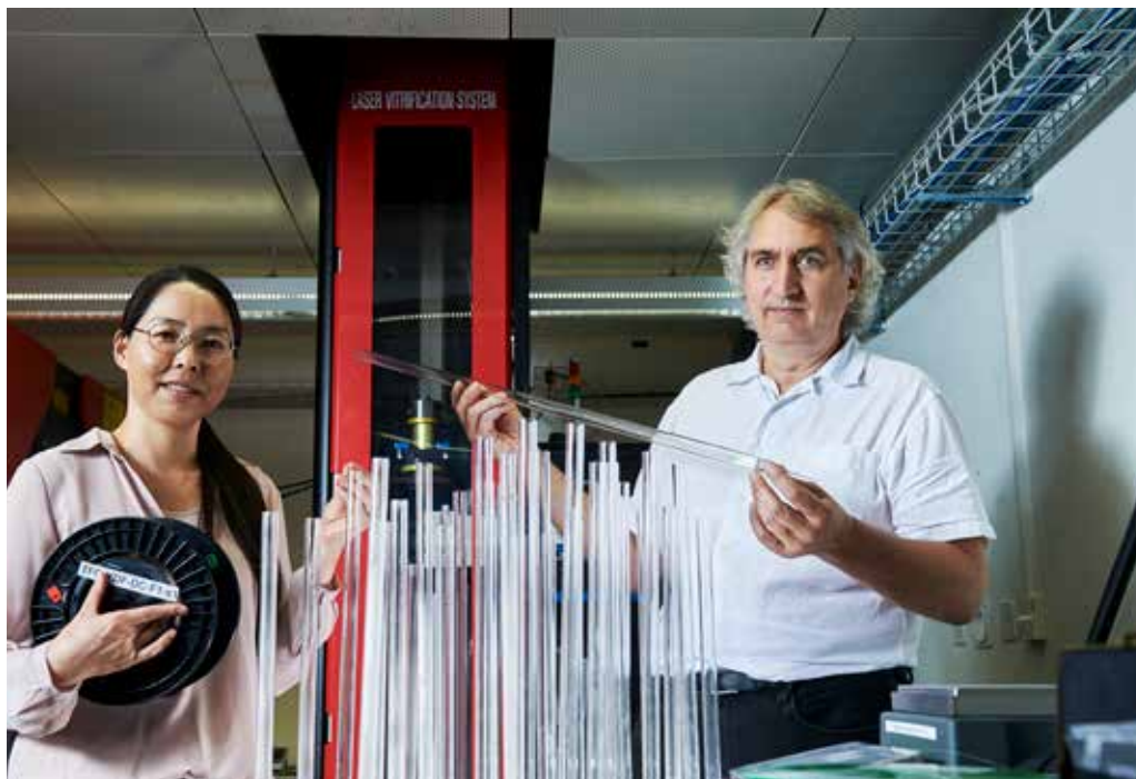
Professor Thomas Feurer und Dr. Hyunjoo Kim vor dem in Bern entwickelten und in Südkorea gebauten «Laser Vitrification System». Mit einem Laserstrahl wird dotierter Quarzsand in Glas umgewandelt. (© Bild: Manu Friederich)
