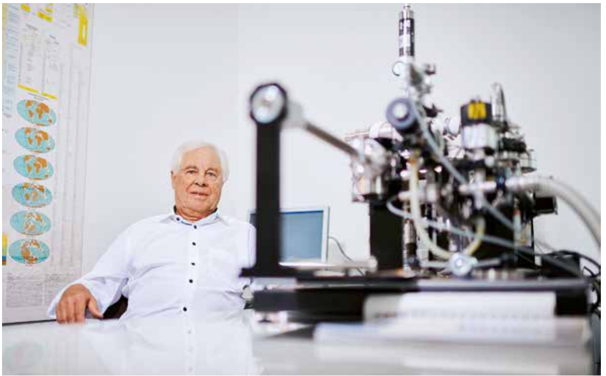
Otto Eugster und sein Massenspektrometer, mit dem er das Alter von Goldobjekten bestimmen kann.
