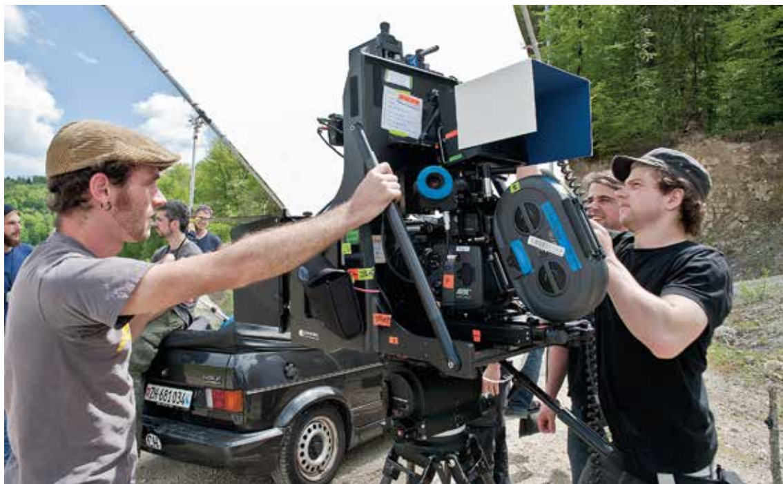
Hier filmen zwei Kameras den genau gleichen Bildausschnitt: Horizontal die analoge 35-Millimeter-Filmkamera Arricam LT und senkrecht die digitale Kamera Arri Alexa.
