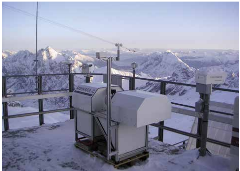
MIAWARA-C (Middle Atmospheric Water Vapor Radiometer) auf der Zugspitze, dem höchsten Berg Deutschlands.
