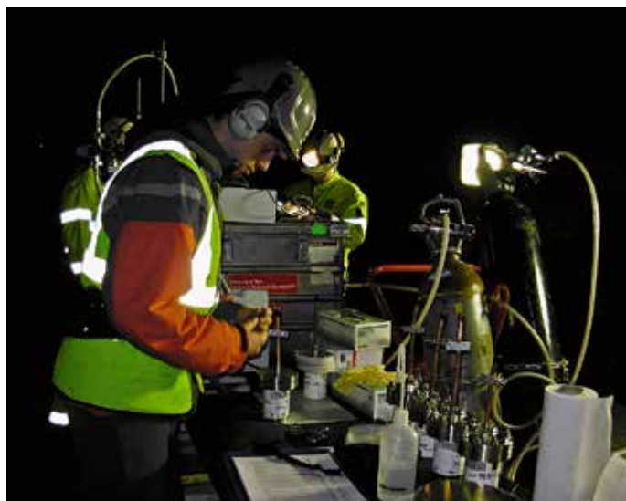
Johannes Hämmerli präpariert die Stahlzylinder, die für die Freisetzung der gelösten Gase verwendet werden.
