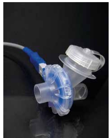
Kleines Gerät mit grosser Wirkung – eFlow Vernebler für eine neue sanfte Therapie für Frühgeborene: Das Medikament wird über in den Trichter oben rechts zur Membran im Innern (blauer Ring) geführt, wo es vernebelt wird. Über die Öffnung links verlässt das vernebelte Medikament das Gerät und gelangt via Nasenschläuche in die Lunge der kleinen Patienten.
