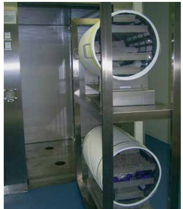
Nahrung, Wasser und Nistmaterial werden im Autoklaven sterilisiert und anschliessend mit Materialboxen an das Schleusensystem der Isolatoren angedockt.
