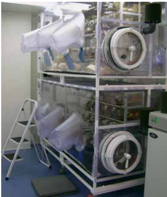
Hightech Isolator mit Überdruck für keimfreie Mäuse. Seitlich sind die Manipulatoren sichtbar.
