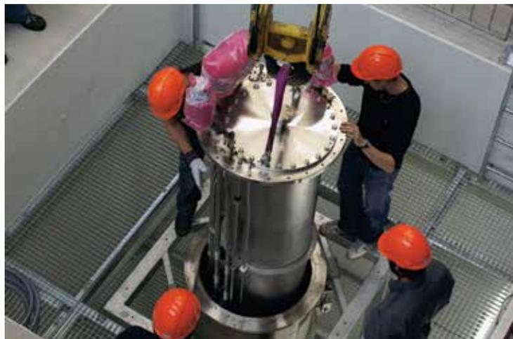
Der «ARGONTUBE» wird im Keller des Gebäudes der Exakten Wissenschaften (ExWi) in den Boden eingelassen.
