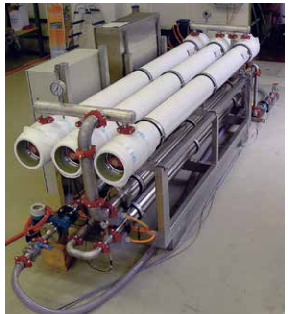
DCT RO Entsalzungsanlage mit einer Kapazität von 170 Kubikmeter Trinkwasser pro Tag. Die Anlage misst 1,7 x 4,5 x 1,4 Meter (H x L x B). Der Test auf Gran Canaria läuft seit September 2005.
