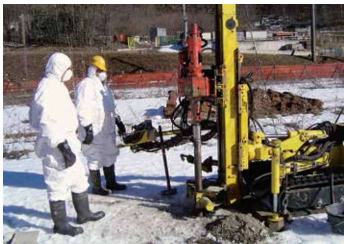
An einem belasteten Standort wird mit Chrom kontaminiertes Untergrundmaterial erbohrt und beprobt.
