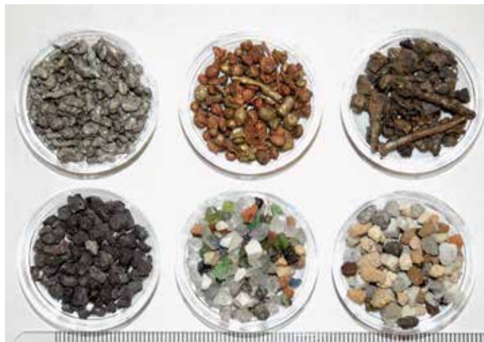
Schlacke aus einer Kehrichtverbrennungsanlage, zerlegt in ihre Bestandteile: Aluminium, Kupfer und Messing, Eisen, eisenhaltige Schlacke, Glas sowie Keramik (von oben links nach unten rechts).
