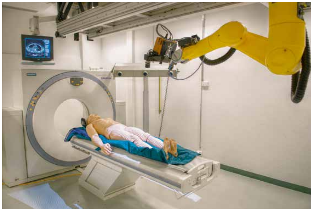
CT-Untersuchungsraum im Institut für Rechtsmedizin. Im Bild zu sehen sind der Computertomograph (links). An die Decke montiert ist der Roboter, der mit dem angebrachten Oberflächenscanner vollautomatisch exakte dreidimensionale Abbilder der Körperoberfläche erfassen kann.
