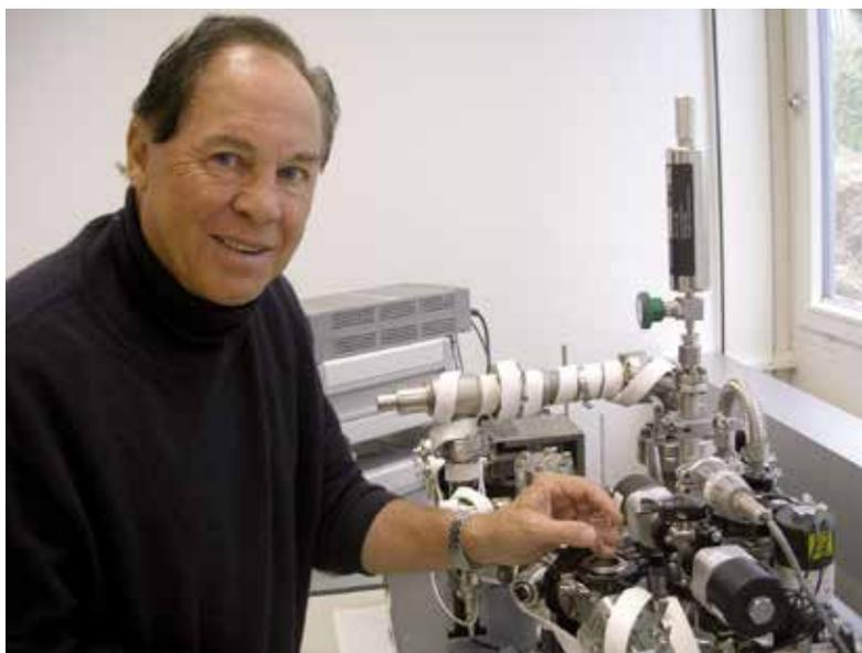
Mit einem Glasrichter führt Prof. Dr. Otto Eugster eine Goldprobe durch die Schleuse ins Spektrometer ein.
